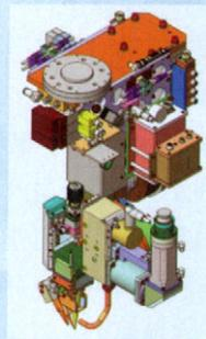
图5 激光加工头示意图（压指型）
